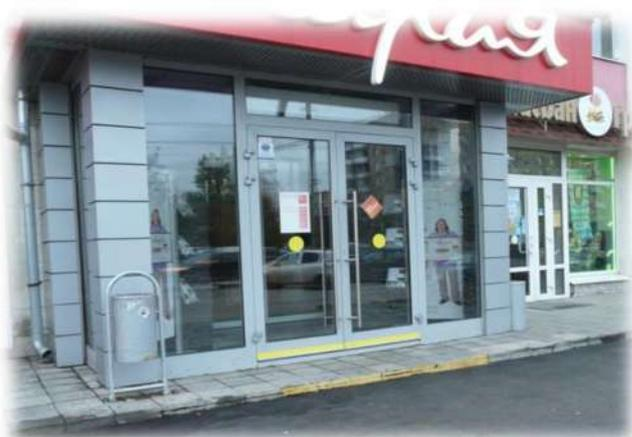
Рекомендовать сгладить площадку пологим пандусом. При затесненной застройке и невозможности устройства пандуса край площадки должен быть выделен контрастной полосой.
