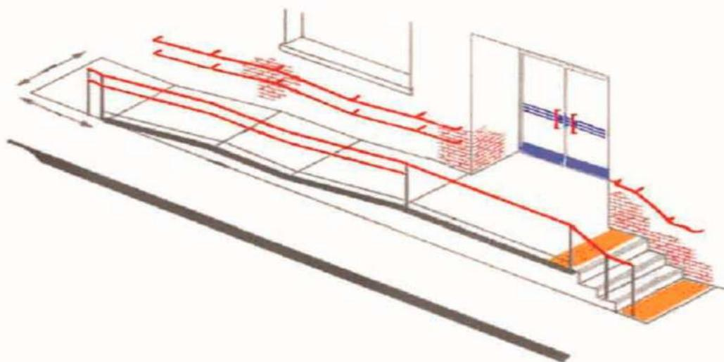
На рисунке показан оптимальный вход в здание, который одновременно имеет и удобный пандус нужной ширины и ступени, оборудованные с обеих сторон поручнями. Дверь должна открываться в сторону, противоположную от пандуса, так как в противном случае могут возникнуть ситуации, в которых инвалид-колясочник, заехав на лестничную площадку, может получить удар открывающейся дверью.
