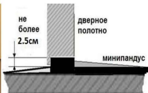
Измеряется вертикальная часть порога. Высокие пороги непреодолимы для колясочников. Доступность при пороге более 2,5 см условная. Измеряется самый высокий порог.
