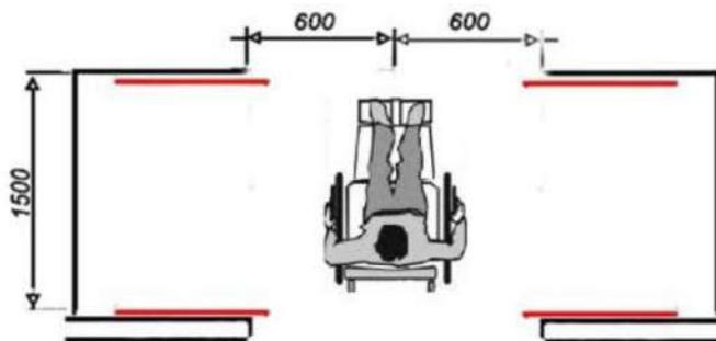
СП 59.13330 5.2.33 На путях эвакуации допускается применение раздвижных дверей при условии, что они:
